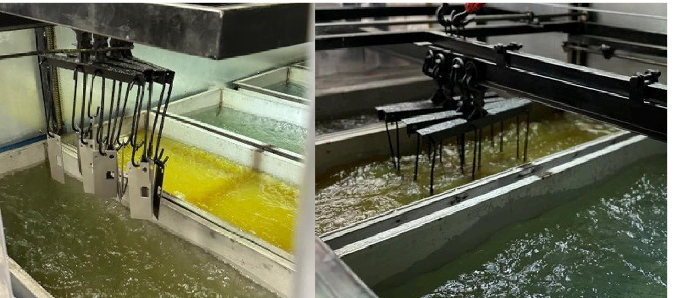
El pretratamiento por circonio es un proceso avanzado que prepara las superficies metálicas para recibir recubrimientos, mejorando significativamente la adherencia y la resistencia a la corrosión. A diferencia de los métodos tradicionales con fosfatos, el circonio ofrece una capa más delgada, uniforme y ecológica, reduciendo el consumo de agua y químicos sin comprometer el desempeño.
