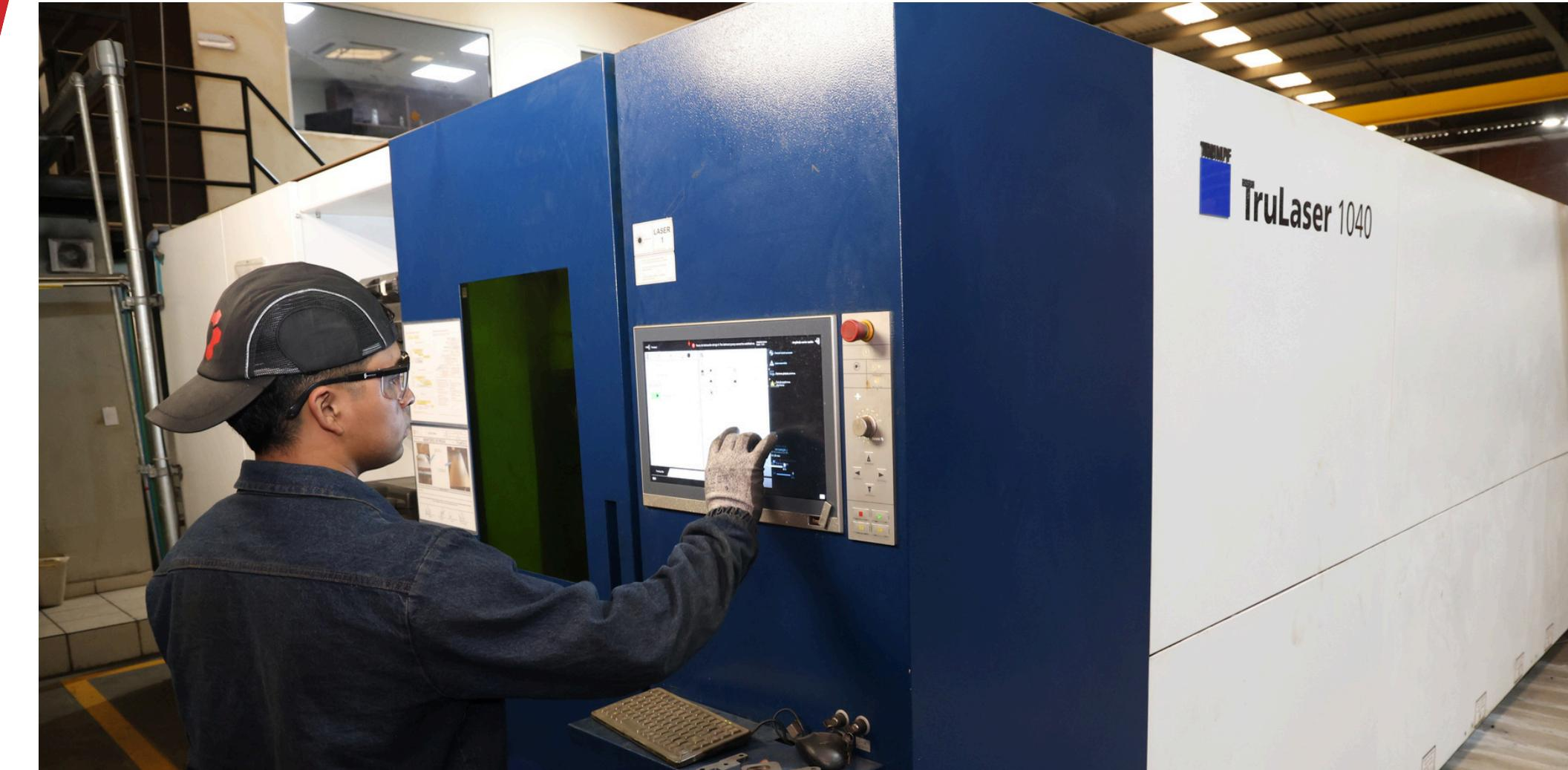
Contamos con tecnología **TRUMPF** de alta precisión para el corte láser de piezas metálicas, desde 1 mm hasta 1" en acero al carbón, inoxidable, aluminio y cobre.
