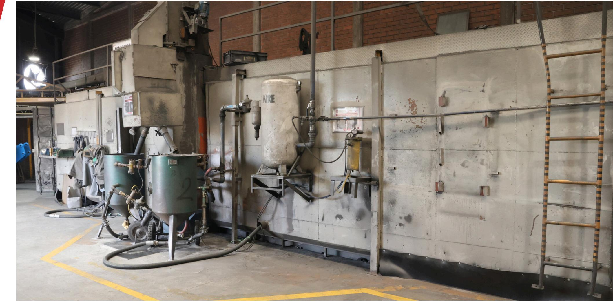
Nuestro proceso de granallado garantiza superficies limpias, uniformes y preparadas para recibir cualquier tipo de recubrimiento. Mediante la proyección controlada de granalla, removemos óxido, cascarilla, pintura y contaminantes, logrando un acabado consistente que mejora la adherencia, prolonga la vida útil de las piezas y eleva la calidad del resultado final.
